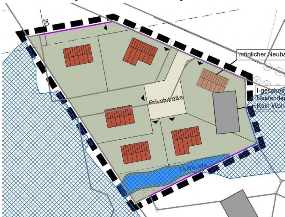
Abbildung 4: Städtebaulicher Entwurf mit Flutmulde | Ergebnis des hydraulischen Gutachtens
